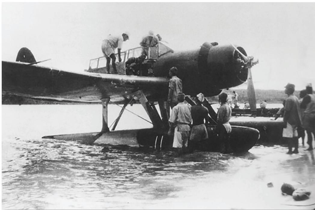
Un Aichi E13A1 pris en main par des mécaniciens à l'issue de son vol. Les *Suitei* étaient ensuite ancrés à quelques mètres du bord, par un mètre de fond voire moins, de sorte que lorsque leurs flotteurs étaient percés, ils se posaient tout simplement sur le sable, parties supérieures émergées. Réservoirs vides, les Américains avaient beau les mitrailler, ils ne s'enflammaient pas et paraissaient toujours intacts vus du ciel. (Archives auteur/DR)
