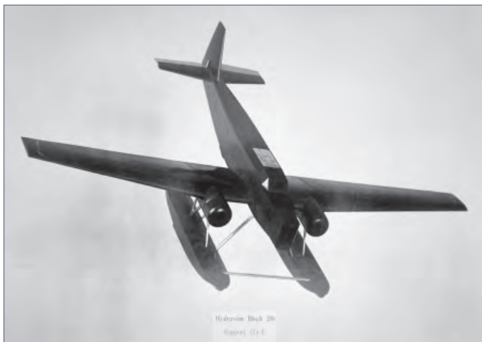
La maquette du Bloch 210 est essayée à la soufflerie Eiffel en configuration hydravion dès octobre 1933, avant que ses flotteurs soient remplacés par un train fixe. En juin 1934, des essais complémentaires seront menés à la soufflerie d'Issy-les-Moulineaux.
