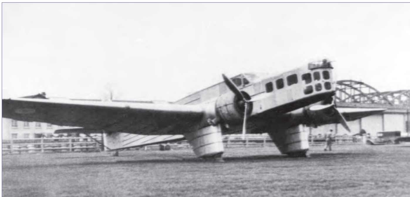
Avant d'installer des flotteurs, le prototype du Bloch 210 est doté d'un train fixe caréné, pour réaliser ses premiers vols de mise au point sur le terrain de Villacoublay en novembre 1934. Sa construction est très proche de celle de son « petit frère », le Bloch 130.
