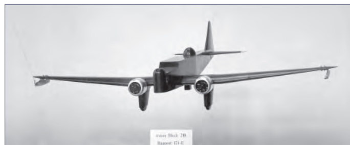
Les premières études en soufflerie sont lancées dès fin 1933 pour le bombardier-torpilleur lourd Bloch 210 destiné à la Marine. La maquette est modifiée en 1934 pour étudier un train fixe destiné à réaliser des essais terrestres avant d'équiper le prototype de ses flotteurs.
