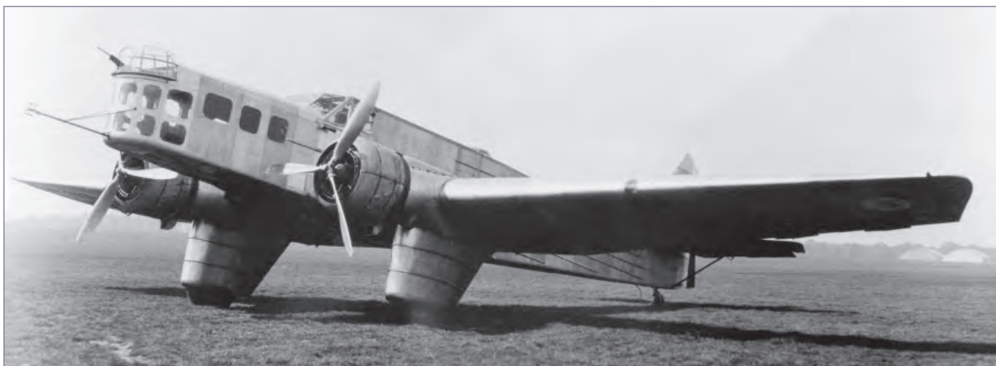
Alors que l'idée initiale était d'adapter le Bloch 200 pour en faire un avion torpilleur, Maurice Roussel propose de remplacer l'aile haute par une aile basse, proche de celle en cours de développement pour le multiplace BCR Bloch 130, plus facile à adapter à des flotteurs.
