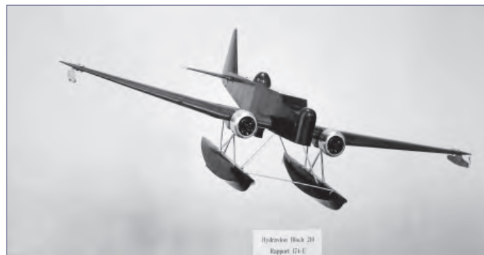
Des tourelles sont ajoutées à la maquette de soufflerie, sur l'avant du nez, sur le dos et sous le ventre du fuselage. Des petits flotteurs supplémentaires sont également disposés sous les extrémités des ailes. Ces derniers ne seront pas retenus.
