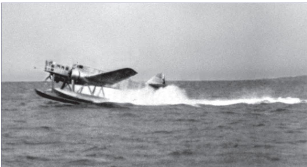
*Le Bloch 210 n° 1 déjauge. Le choix de l'aile en position basse proposé par Maurice Roussel permet d'adapter les flotteurs plus facilement avec une mâture plus courte et résistante.*
