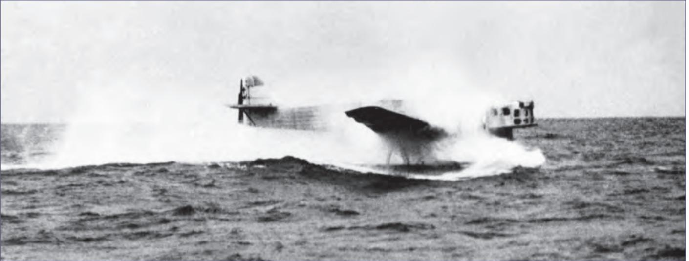
Le 4 mars 1937, Le Bail réalise avec succès le spectaculaire essai dit du « mètre de creux » à bord du Bloch 210. C'est le dernier essai officiel qui clôt la campagne de mise au point.
