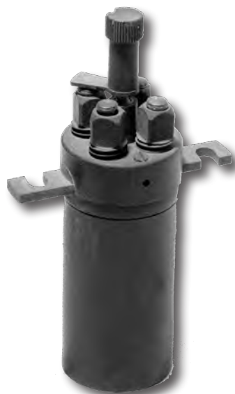
Détecteur électrolytique de Ferrié, version industrialisée (Coll. Musée des arts et métiers. Photo A. Salles).
