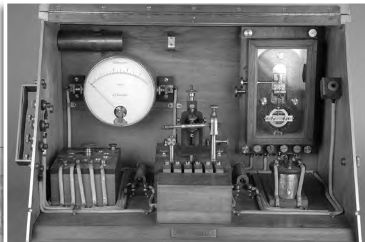
Récepteur à cohéreur modèle 1904 de la station de Belfort. Il est monté dans un coffret métallique dont un volet avant forme pupitre. Il équipera les grands bâtiments de la Marine. (Coll. Musée des arts et métiers. Photo A. Salles.)
