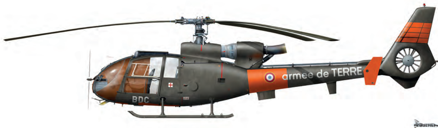
SA 341F2 n°1038/BDC, ESALAT, Dax, 1986 Comme toutes les Gazelle alors affectées en école à Dax ou au Luc, la « BDC » porte les larges panneaux dayglo autocollants. Elle est en outre équipée des panneaux VSV amovibles et translucides pour une séance d'instruction au vol aux instruments.
