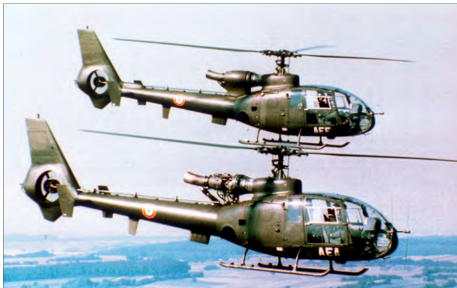
Deux des premières SA 341 de l'EHL du GALCA 1, dans leur configuration originelle, sans armement ni bossage pour la lunette de visée. Le vol avec les capots de la BTP ou du GTM démontés (comme sur l'appareil au premier plan) est une pratique assez courante dans l'ALAT. (Coll. F. Saint-Arroman)
