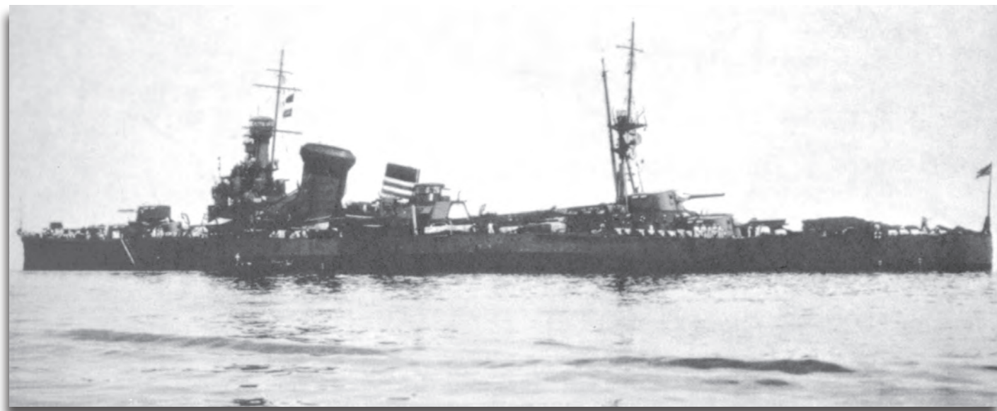
Le Kako au mouillage à Kure le 21 juin 1928. Vue unique du croiseur avec sur la cheminée avant un système de déflecteur de fumée expérimental.
