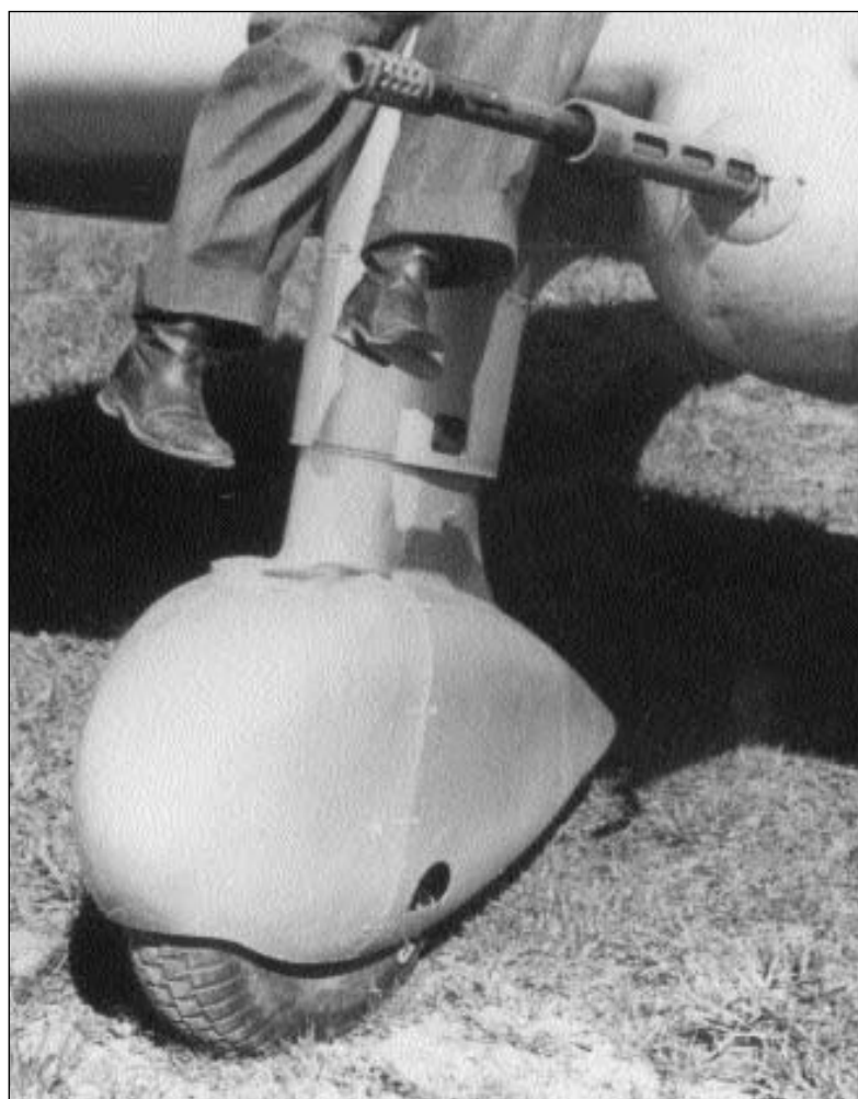
Les canons Madsen étaient logés dans de grosses gondoles sous la voilure. L'installation différait de celle du FR-76 finlandais pour le canon Oerlikon. The Madsen guns were mounted in big fairings under the wings. The installation differed from the Finnish one for the Oerlikon guns.
