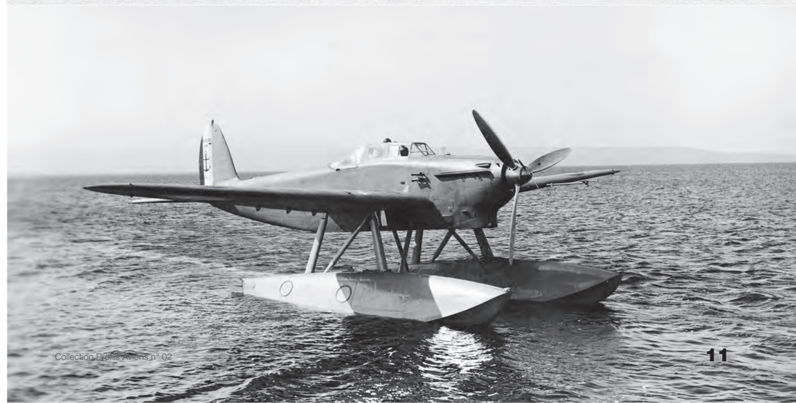
Le Latécoère 298 N° 01 photographié fin 1936 ou début 1937 à Fréjus-Saint-Raphaël lors de la première séance d'épreuves à la CEPA. La verrière d'origine à la visibilité réduite sera l'un des rares changements qui sera demandé par la Marine. (Coll. JC. Soumille)
