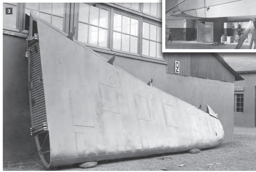
Ci-dessus: Partie externe de la voilure repliable tribord sur Latécoère 298 B.
