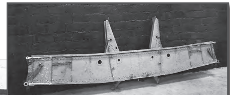
Les longerons avant (en haut) et arrière (en bas) de la partie centrale de l'aile sur Latécoère 298 A et D. (© Musée de l'hydraviation)
