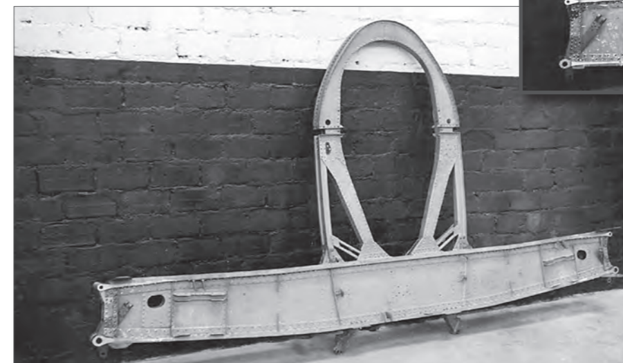
Les longerons avant (en haut) et arrière (en bas) de la partie centrale de l'aile sur Latécoère 298 A et D. (© Musée de l'hydraviation)
