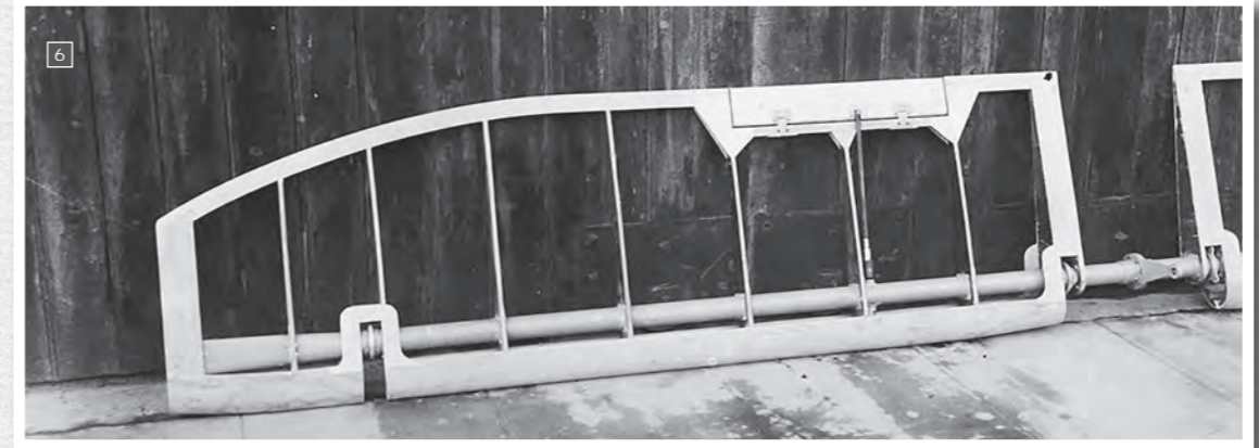
Parties fixe et mobile de l'empennage horizontal de la version B. Sur ce document, les extrémités de la partie fixe sont repliées. (@ Musée de l'hydraviation)
