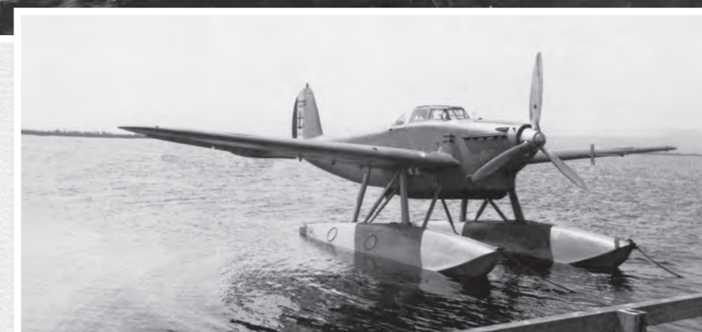
Autre vue du prototype aux Hourtiquets en 1936. Une maquette de torpille est à poste dans la soute. La barre transversale reliant les deux flotteurs n'est pas encore montée. (© Musée de l'Hydraviation)
